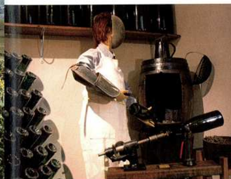
Au premier plan, une machine à déboucher, dite bossin, prépare le dégorgement, qui consiste à éjecter les dépôts de vieillissement accumulés dans le goulot.
