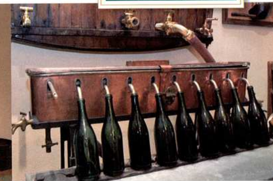
Cette tireuse à dix bords, accordée au foudre, sert à remplir les bouteilles. Dans la machine, des flotteurs gèrent le niveau pour empêcher le jus de déborder.
