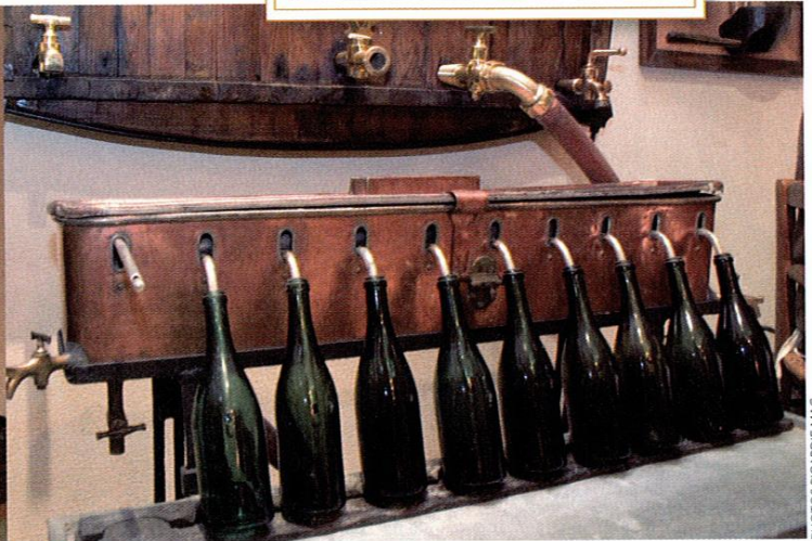
Cette tireuse à dix becs, accordée au foudre, sert à remplir les bouteilles. Dans la machine, des flotteurs gèrent le niveau pour empêcher le jus de déborder.
